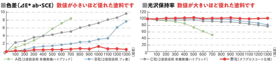
一般的に耐候性が弱いとされている青系の塗料でも試験を実施しました。20年相当の試験結果でもこのように良好な結果を示しています。
