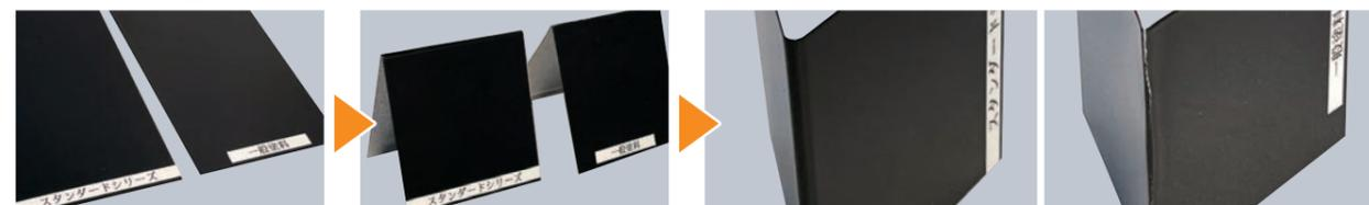
●新品のガルバリウムに「スタンダードシリーズ」と一般塗料をそれぞれ基材に塗装 ●塗装面を山側にして折り曲げる ●「スタンダードシリーズ」柔軟性があるので亀裂のない塗装面 ●一般塗料柔軟性がないので亀裂が発生
