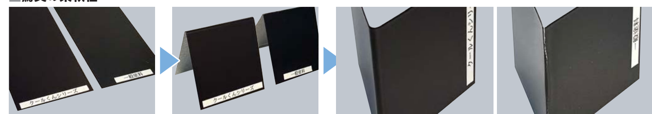
●「クールくんシリーズ」と一般塗料をそれぞれ基材に塗装 ●塗装面を山側にして折り曲げる ●「クールくんシリーズ」柔軟性があるので傷のない塗装面 ●一般塗料柔軟性がないので亀裂が発生
