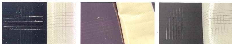
●スレート ●ガルバリウム ●ガラス ■試験方法/①各基材に弊社塗料を直接塗装②乾燥後塗膜にクロスカット(基準目試験)③強力ガムテープを貼り付け、剥がす
