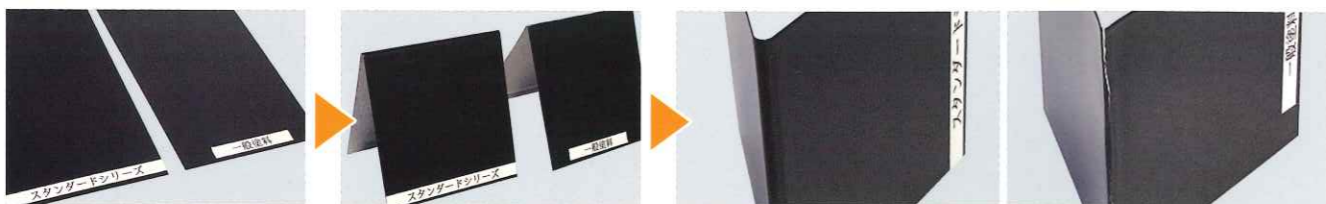
●新品のガルバリウムに「スタンダードシリーズ」と一般塗料をそれぞれ基材に塗装 ●塗装面を山側にして折り曲げる ●「スタンダードシリーズ」柔軟性があるので亀裂のない塗装面 ●一般塗料柔軟性がないので亀裂が発生
