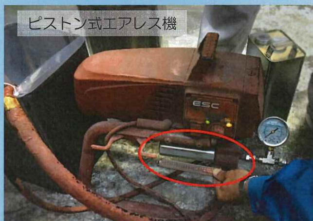
中間フィルターと、フィルターの取り付け位置
