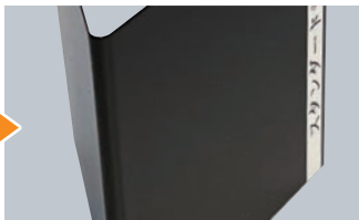
●「スタンダードシリーズ」 柔軟性があるので亀裂のない塗装面
