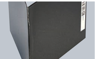
●一般塗料 柔軟性がないので亀裂が発生
